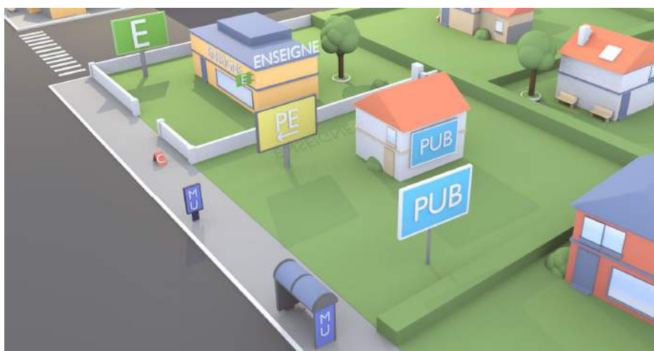
Exemples de dispositifs : Publicité scellée au sol ou sur support (PUB) ; publicité sur mobilier urbain (MU) ; préenseigne scellée au sol (PE) ou posée au sol (C) ; enseignes à plat, perpendiculaire (E), en toiture et scellée au sol (E).
