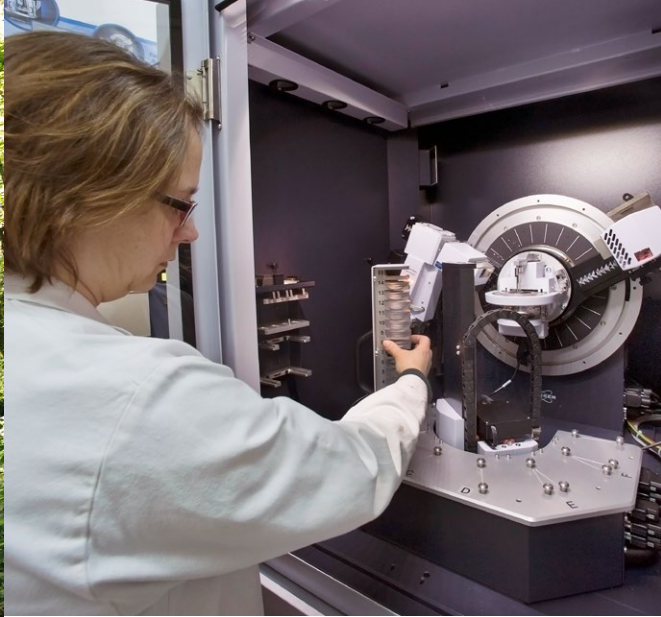
▲ Opération de de caractérisation de sols et diffractométrie des rayons X. © TERRA - LAURENT MIGNAUX
