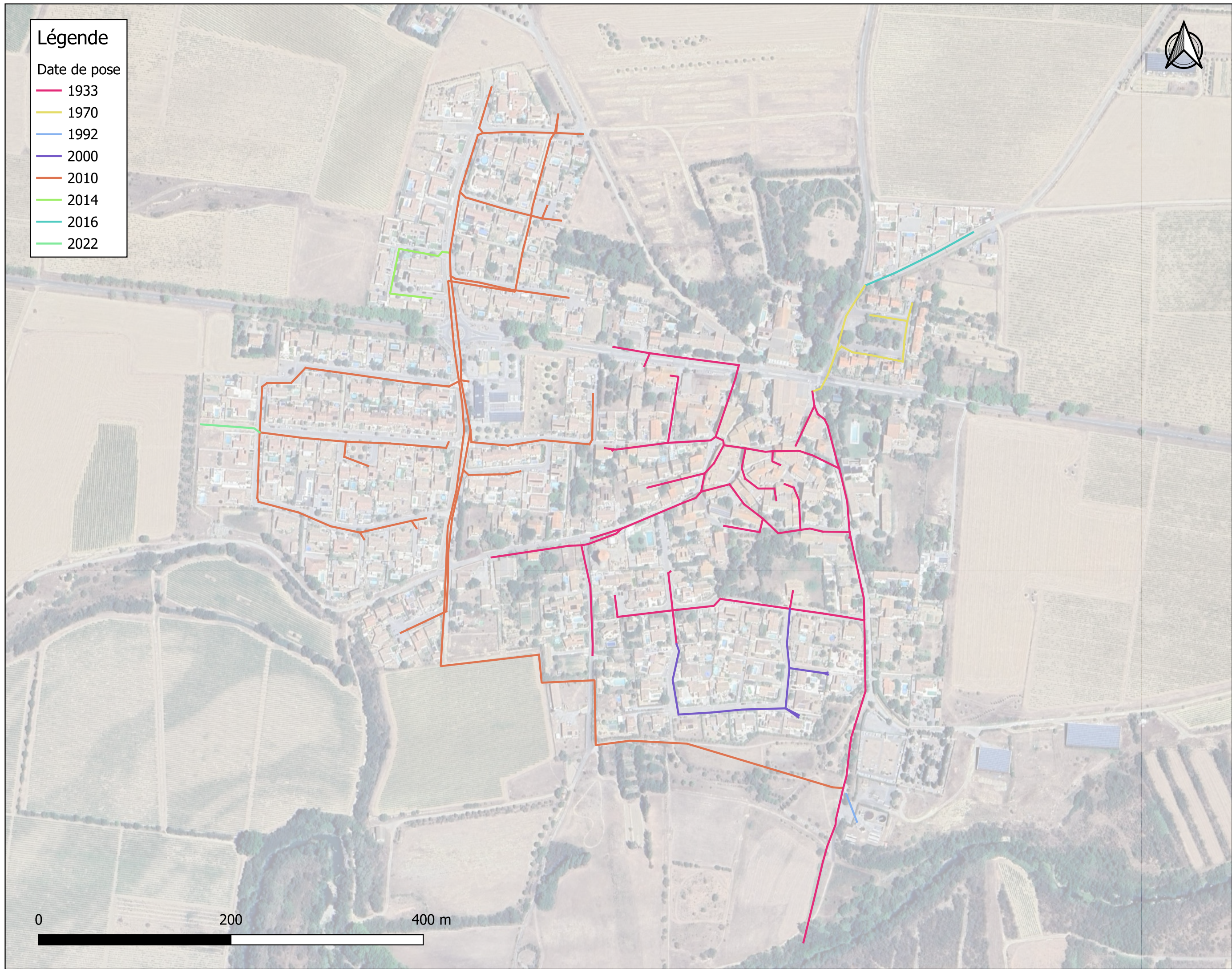
Datse de pose du réseau EU Cruscades
